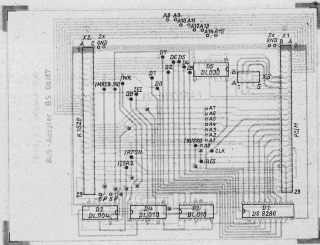
Bild 5: Bestückungsplan der Adapterleiterplatte
