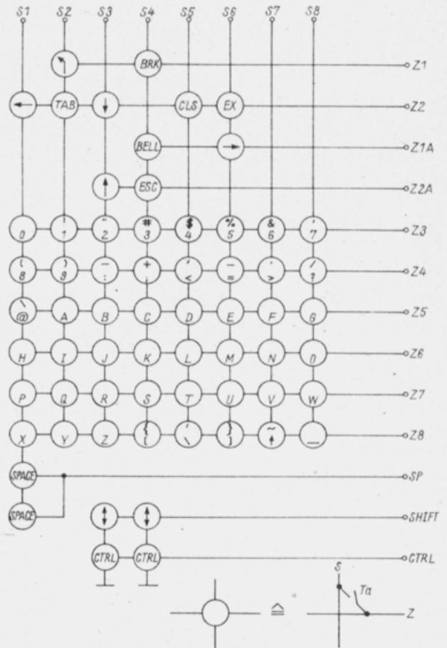
Bild 16a: Layout der Bestückungsseite der Platine für die Tastaturelektronik
